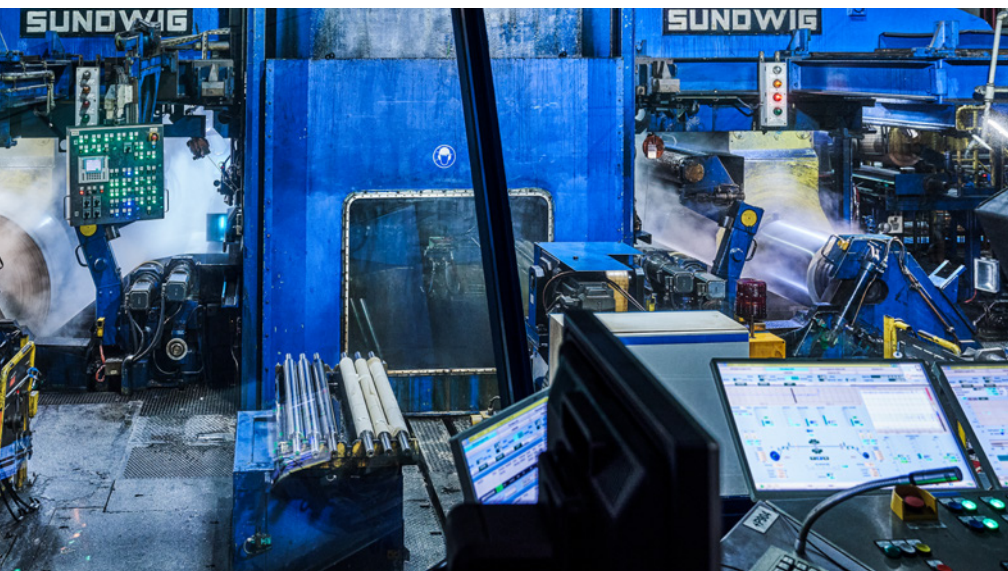
Bild 1. Das 20-Rollen-Kaltwalzgerüst „Sundwig 1350“ im Werk Dillenburg. Das VTLG ist links an der hellblauen Kontrollleuchte neben dem Bedienpult am Gerüst zu erkennen (Foto: Vollmer)
