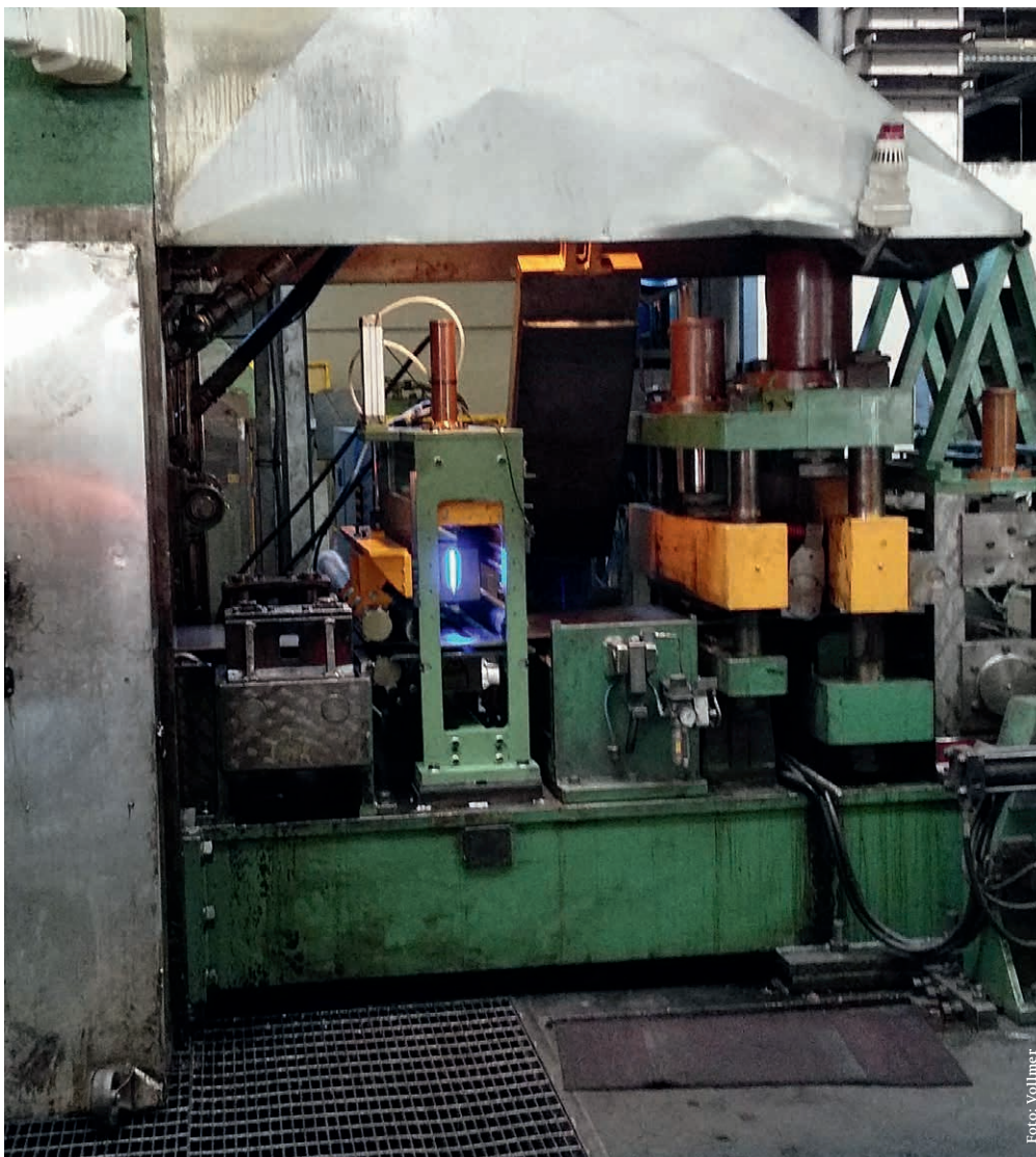
Ein laseroptisches Dickenmessgerät VTLG an einem Quarto-Walzgerüst bei I.T.L.A. Srl in Oggiono, Italien
