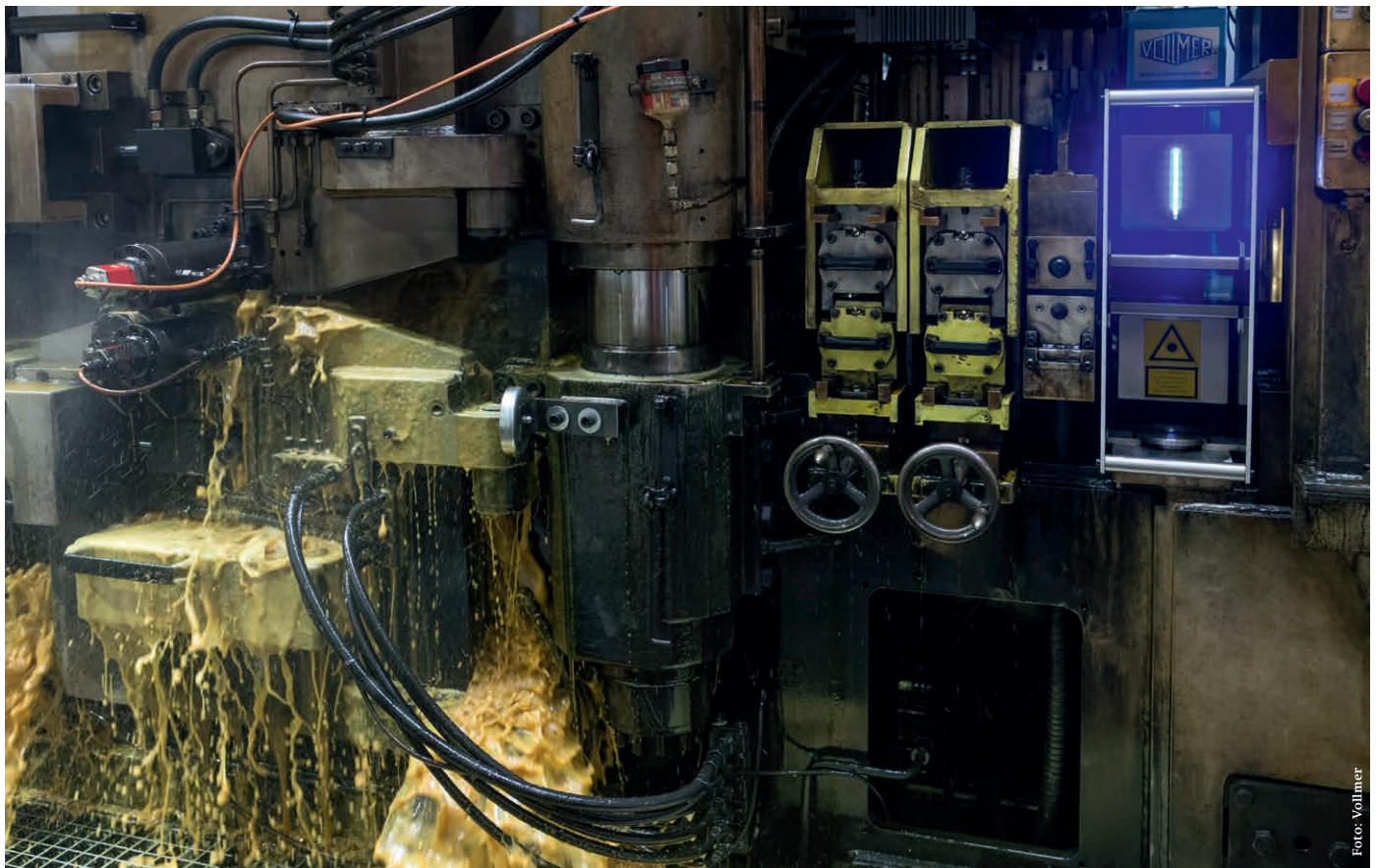
An einem 20-Rollen-Kaltwalzgerüst der Philipp Boecker + Wender Stahl GmbH & Co. KG (BWS) erzielt ein Dickenmessgerät VTLG trotz dichten Ölnebels Messgenauigkeiten von \pm 1 \mu\text{m}
